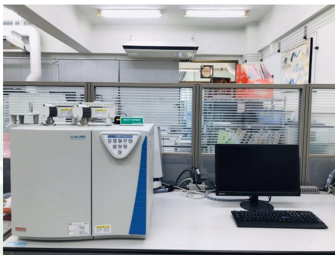
ภาพที่ 14 เครื่องมือวิเคราะห์องค์ประกอบของธาตุ ที่มา : (ศูนย์เครื่องมือวิทยาศาสตร์ มหาวิทยาลัยสงขลานครินทร์)
