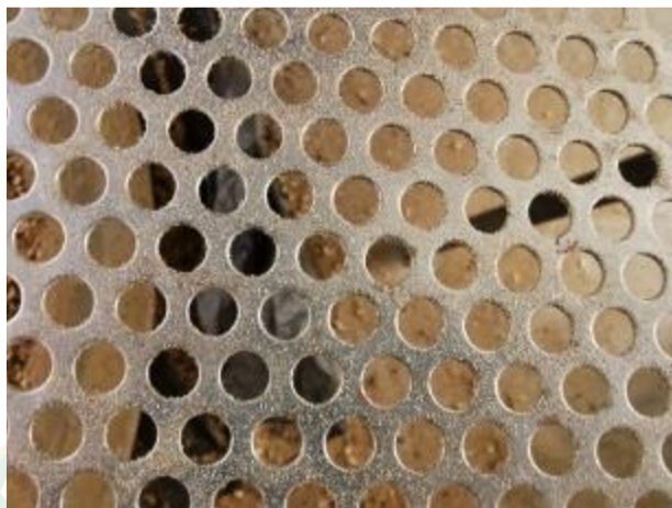
ภาพที่ 10 ตาข่ายที่ใช้ในการลดขนาดของชีวมวล
