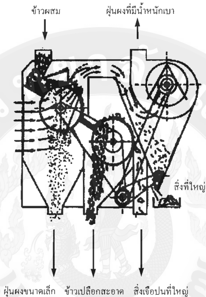
ภาพ 8 เครื่องทำความสะอาดด้วยลมเป่าและลูกกลิ้งหมุนแบบเยอรมัน ที่มา: Shengyan (1998 อ้างโดย อรอนงค์, 2550)
